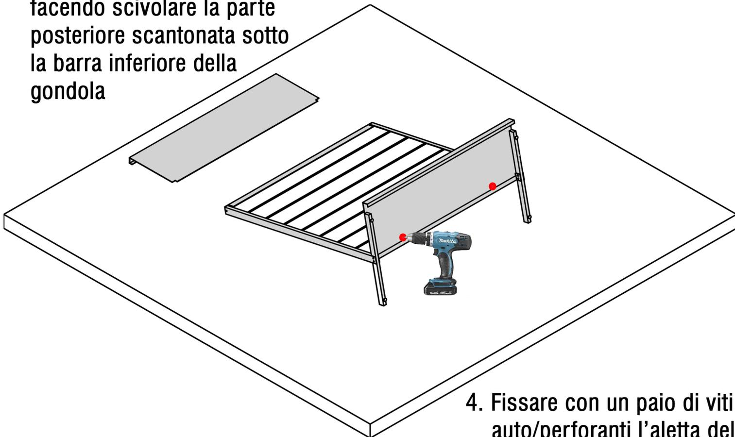
**4. Fissare con un paio di viti auto/perforanti l'aletta del piano alla barra inferiore**
